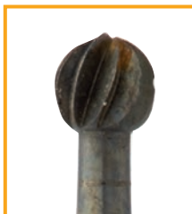
Broca corroída de acero para herramientas. Causa: material no adecuado para la limpieza mecánica sin revestimiento protector a la corrosión.
