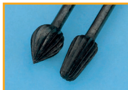
Óxido en las fresas. Causa: Tratamiento de un instrumento de un sólo uso
