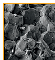
Detalle: Pinzas de boca partida con estructura fracturada intercristalina granulada típica.
