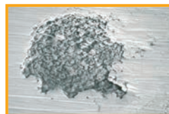
Picadura – observada al microscopio electrónico de superficie – aumento x200
