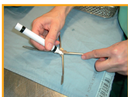
Lubricado de los instrumentos con frasco pulverizador de aceite o lápiz lubricador
