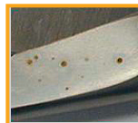
Tijeras con corrosión de picadura
