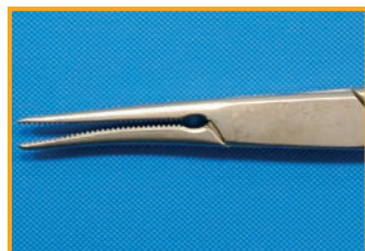
Deformación debida a manejo inadecuado
