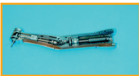
Estructura interior de la pieza de mano y pieza acodada
