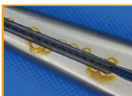
Costura de soldadura corroída en un portaagujas de metal duro y en unas tijeras de metal duro. Causa: ataque de ácido fosfórico debido a sobredosificación de la sustancia de neutralización.
