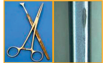
Corrosión de contacto: Acero inoxidable/latón
