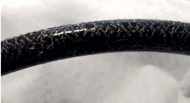
Desprendimiento de la superficie del tubo de inserción
