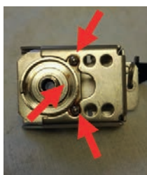
Corrosión en el adaptador
