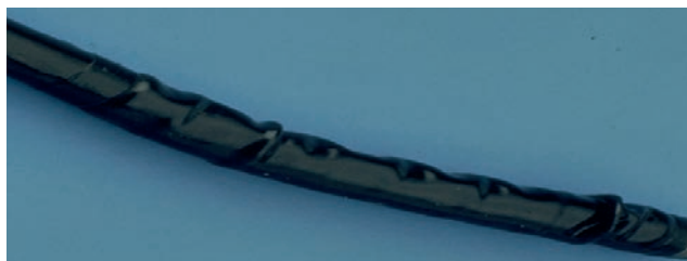
Formación de pliegues en el tubo de inserción debido a tirones demasiado fuertes hacia el extremo distal
