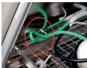
Tubo adaptador aplastado
