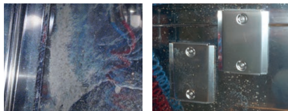
Manchas, adherencias en la cámara de limpieza
