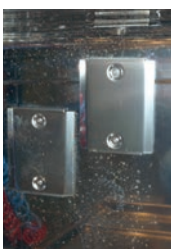
Corrosión en el aparato de limpieza y desinfección de endoscopios (ALD-E)
