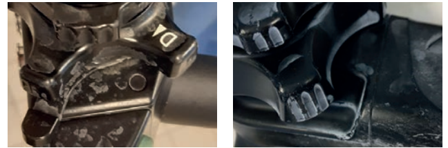
Almacenamiento inadecuado de los endoscopios flexibles, así como de las válvulas en contenedores colectivos. Adherencia debido a los contenidos del agua en la pieza de control
