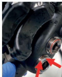
Corrosión en el cuerpo de la válvula
