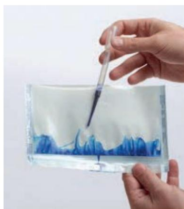
Fig. 8: Prueba fallida (canalización)
