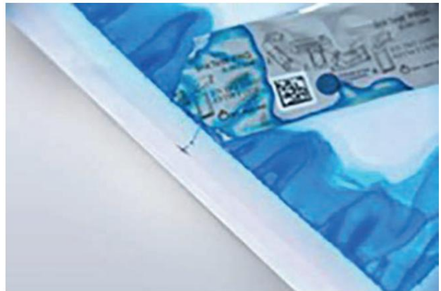
Fig. 6: Prueba fallida (canalización)
