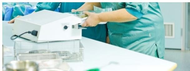
unos de los diseños de sistema de barrera estéril. Es necesario que se establezca la combinación correcta de temperatura, presión y tiempo/velocidad de sellado. Preferiblemente, solo deben usarse dispositivos de sellado fabricados y destinados a uso médico.
