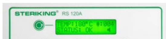
de 165-200 °C (329-392 °F). Se recomienda que la fuerza de sellado sea como mínimo de 95 N y como máximo de 120 N. El tiempo de sellado del sellador por calor normalmente no es ajustable; la velocidad del sellador por calor suele ser de 8 m/min a 10 m/min. Los parámetros requeridos pueden variar según la calidad y el tipo de sellador utilizado.
